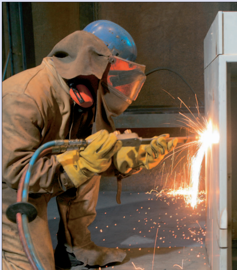
Angriff auf ein Wertbehältnis bei der Prüfung in den Vds-Laboratorien
