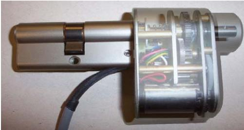
Bild 5: Motorzylinder
