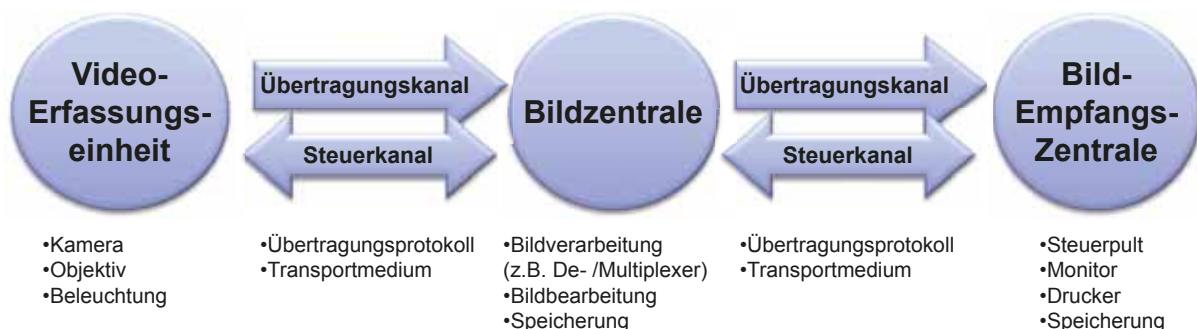
Bild 14-1: Schema einer Videoüberwachungsanlage
