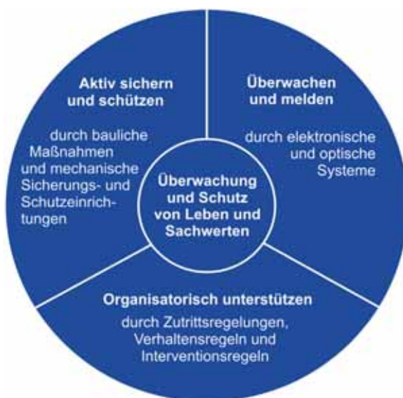
Bild 4-4: Bestandteile eines ganzheitlichen Schutzkonzeptes
